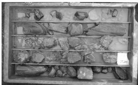
图 11 孤石爆破预处理芯样
