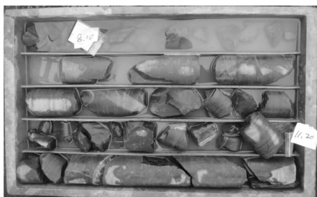
图 12 基岩凸起段爆破预处理芯样
