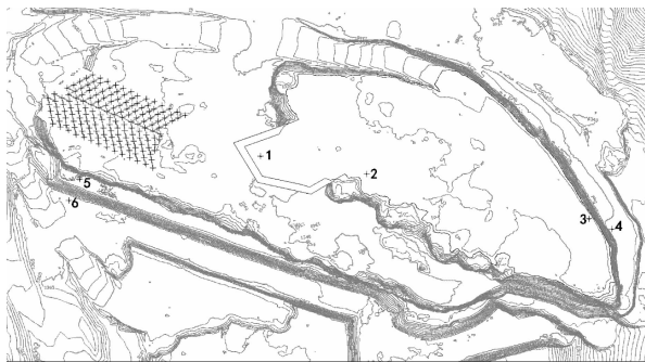
图 3 1340 ~ 1328 m 台阶爆破区域测振点布置示意图 Fig. 3 Vibration measurement point layout in the 1340 ~ 1328 m blasting area
