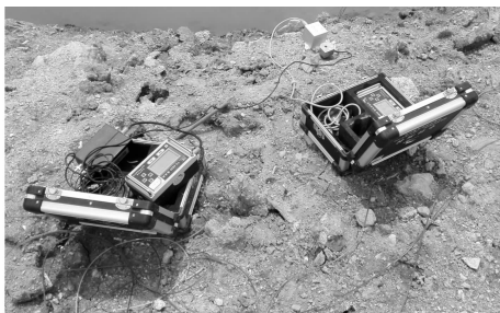
图 3 测量爆破振动图 Fig. 3 Measurement of blasting vibration diagram
