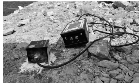
(d) 距爆心 9 m 处监测点 (d) Monitoring point at 9 m from the center of the explosion
