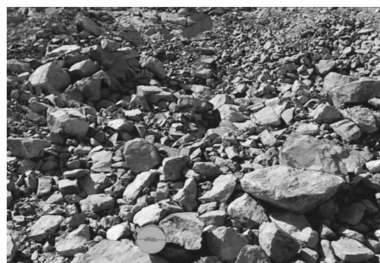
图2 爆破区块爆破后矿石块度分布示例
