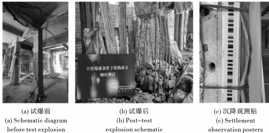
图 4 立柱试爆与沉降监测
