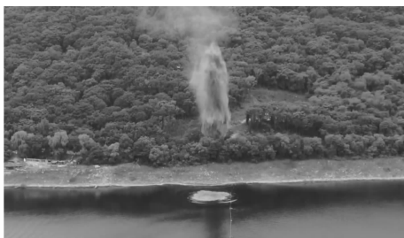
图3 1:1 岩塞爆破试验效果图
