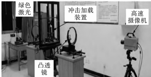
图 2 数字激光动态焦散线实验系统示意图
