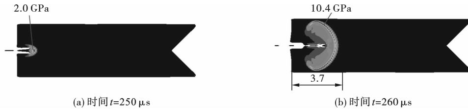
图6 炸药间隔距离70 cm时被发乳化炸药压力云图(单位:cm)
