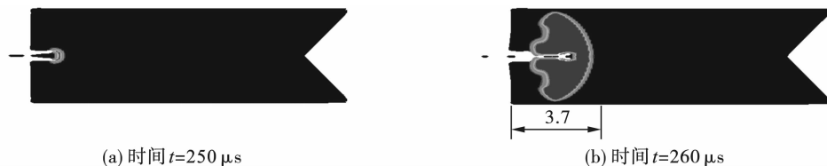
图9 炸药间隔为70 cm时被发乳化炸药反应度云图(单位:cm)
