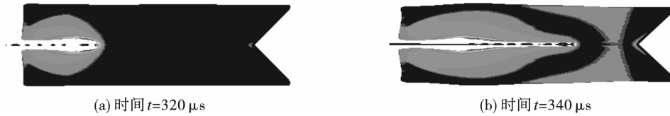
图 10 炸药间隔为 90cm 时被发乳化炸药反应度云图
