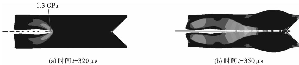
图7 炸药间隔距离90 cm时被发乳化炸药压力云图
