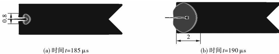
图8 炸药间隔为50 cm时被发乳化炸药反应度云图(单位:cm)
