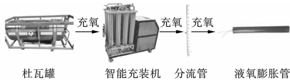
图1 液氧膨胀破岩作业设备图
