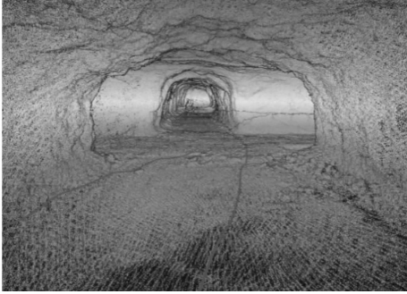
图1 地下矿SLAM即时定位与构建应用实例
