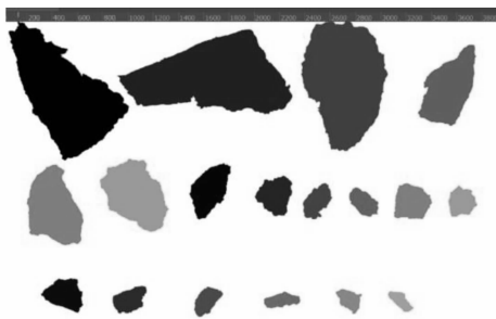
图4 抵抗线 W=6.5 cm 试验的块度色块图
