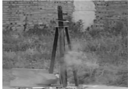
图6 药剂在管内被引燃
