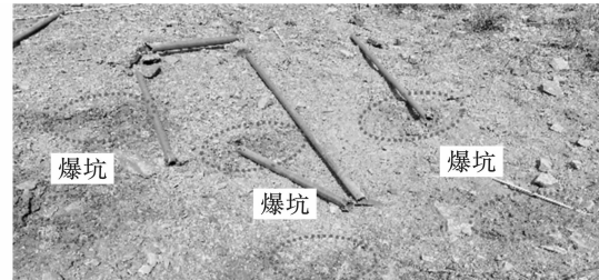
图 4 被发炸药完全起爆的整体效果
