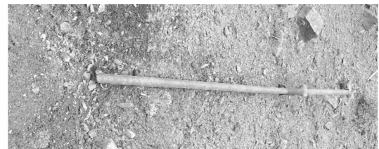
图 6 被发炸药为发生完全起爆的整体效果
