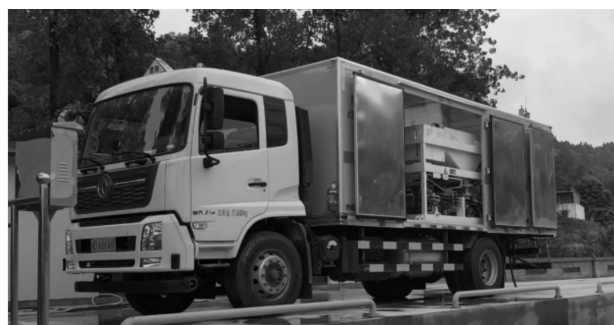
图1 隧道现场混装炸药装药设备
