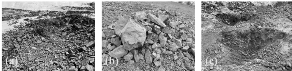
图 5 双孔爆破漏斗试验相关实拍
