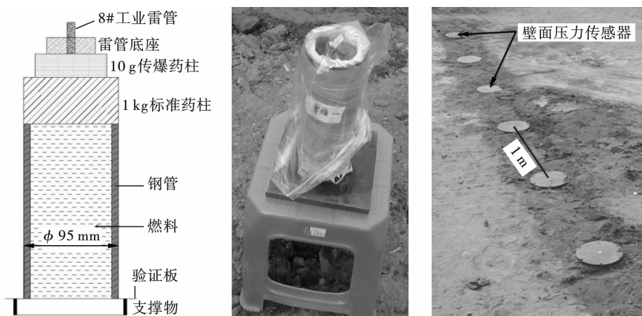
图 1 冲击波感度测试方法
