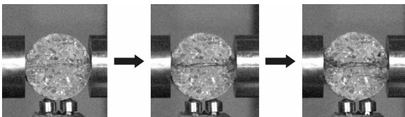
图 11 典型钢纤维混凝土试样劈裂裂纹扩展高速摄影
