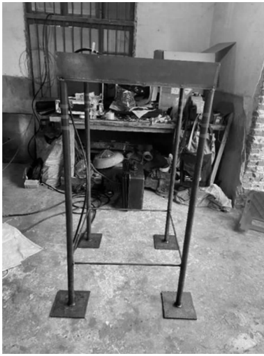
图2 实验所使用的固支方板
