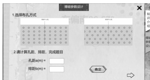
图8 炮孔间距设置
