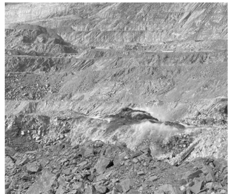
图 2 矿山生产爆破现场
