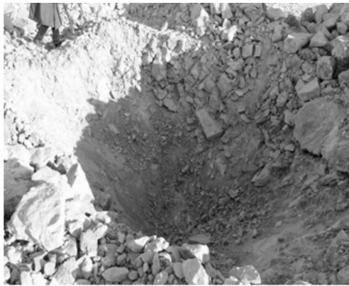
图 3 现场爆破漏斗图
