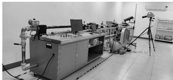
图 1 50 mm SHPB 试验装置
