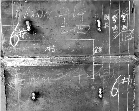
图 1 BT620QL6 焊接板的取样位置
