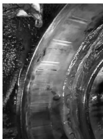
图 4 轴承外圈磨损情况
