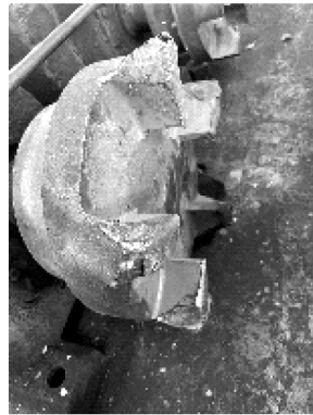
图 3 减速机接手打齿
