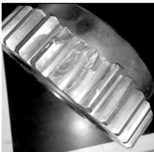
图 2 减速机齿轮断齿
