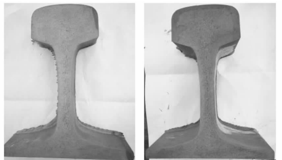
图 5 铸坯尺寸 280 mm × 380 mm U75V 钢轨低倍形貌照片
