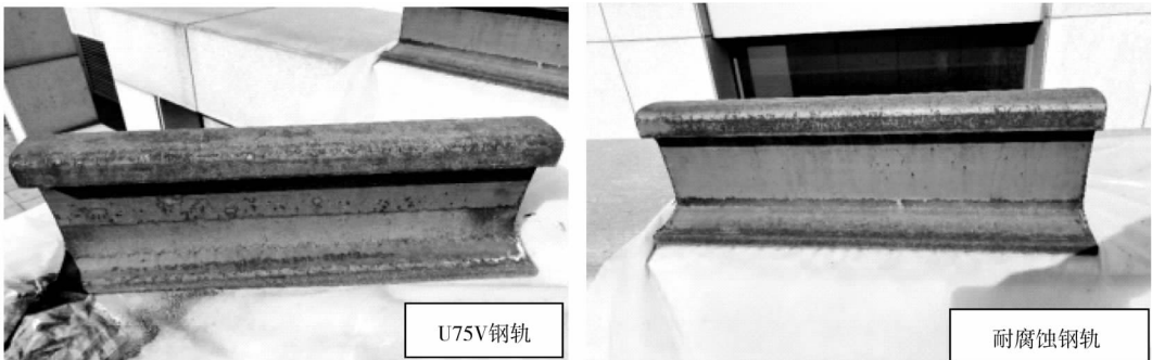
图5 U75V钢轨、耐腐蚀稀土轨露天腐蚀试验(12个月)
