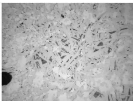
图3 3 # 烧结矿,磁铁矿与针状铁酸钙交织结构
