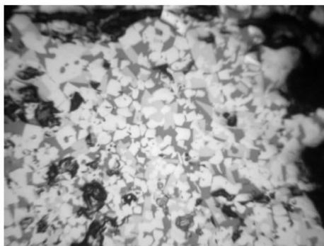
图2 2 # 烧结矿,磁铁矿、铁酸钙及液相富集
