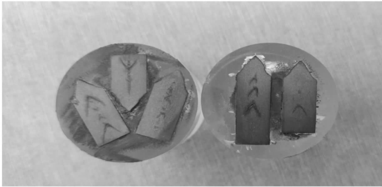
图 2 制样后内部缺陷
