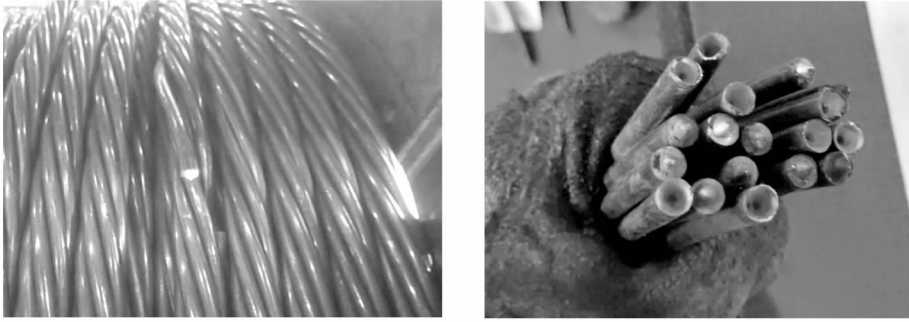
图 1 SWRH82B 盘条表面宏观缺陷及断口宏观形貌
