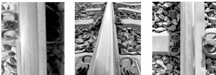
(a) 未打磨表面 (b) 通过 30 Mt 轨面形貌 (c) 通过 30 Mt 缓圆处轨面形貌
