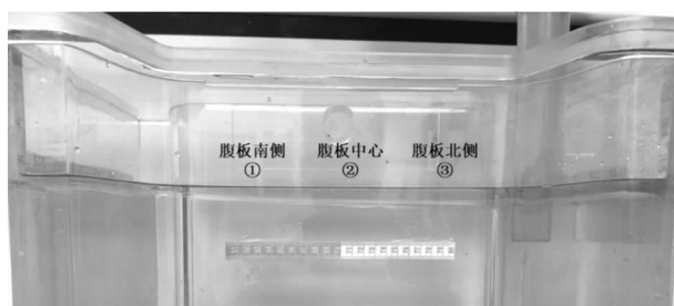
图 6 结晶器断面不同位置液渣分布
