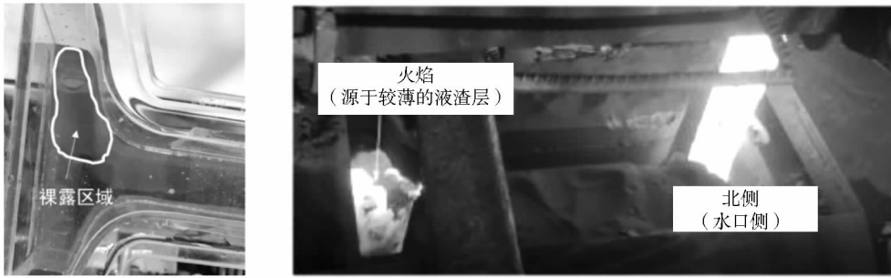
图7 水模拟以及现场生产结晶器南侧观察到的裸露区域
