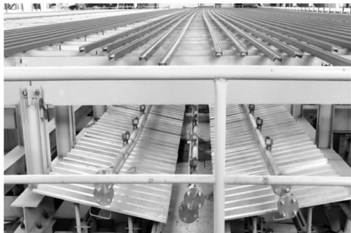
图 3 2018 年鞍钢冷床在线喷雾冷却改造实景图
