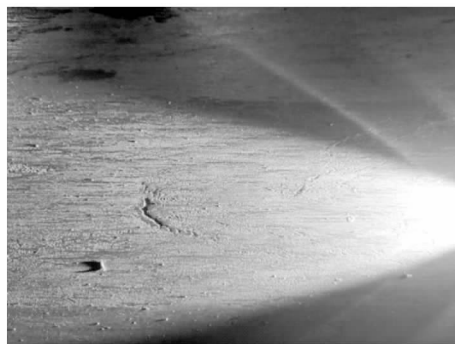
图4 成品 H 型钢腹板宏观缺陷
