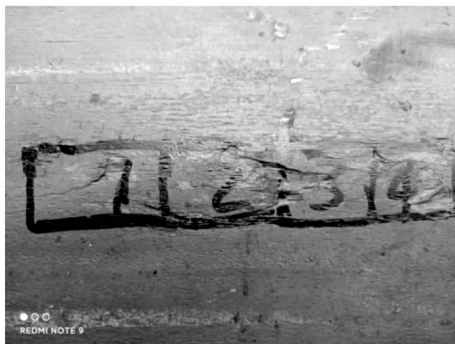
图 4 钢管缺陷处取样示例
