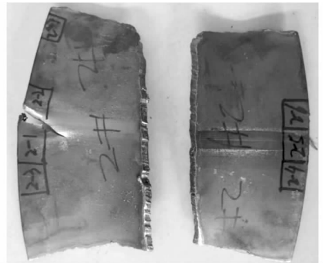
图 1 开裂及对偶试样的宏观形貌
