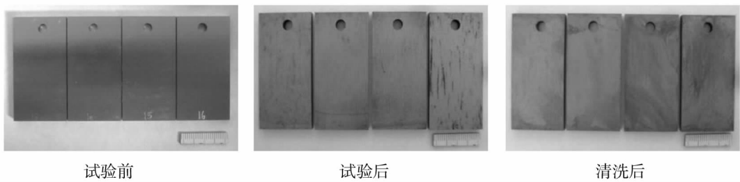
图 4 Q355B 全浸腐蚀试验照片
