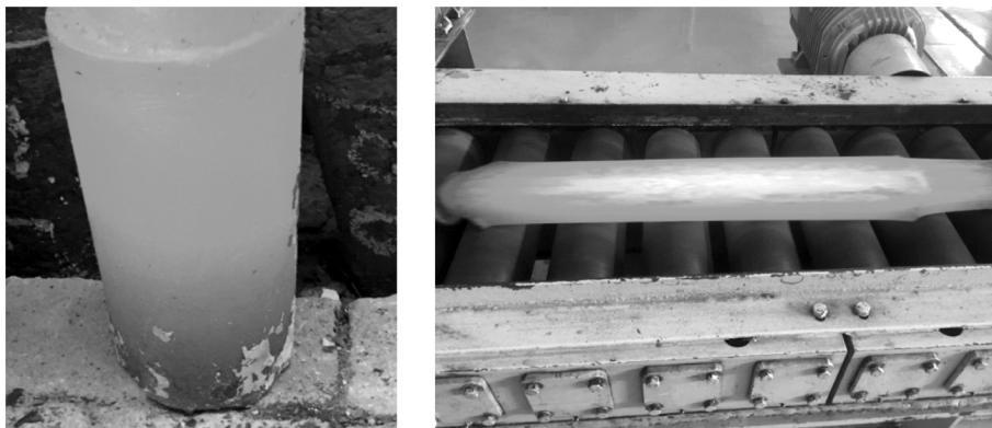
图6 钢锭和热轧板材表面质量
