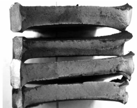
图8 落锤断口形貌
