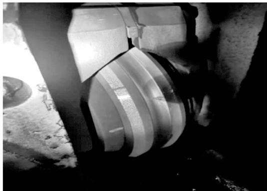
图 5 机芯下线辊环与法兰盘错位
