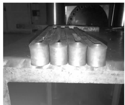
图 6 冷弯试样对折情况
