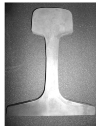
图1 钢轨低倍热酸检验照片
