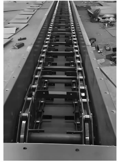
图 1 典型双链结构中槽实拍图
