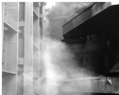
图 1 装煤时机侧炉口冒烟情况
