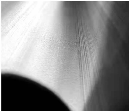
图 4 硼砂原因造成的内直道
