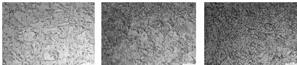
(g) 20 °C/s (铁素体+贝氏体) (h) 50 °C/s (铁素体+贝氏体) (i) 182 °C/s (铁素体+贝氏体)
