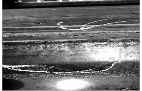
图 1 铸坯横裂纹实物图
