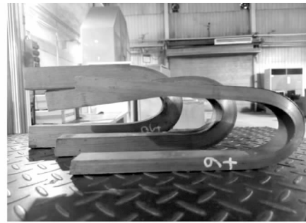
图1 特种越野车防护底板用钢不同厚度钢板冷弯照片
