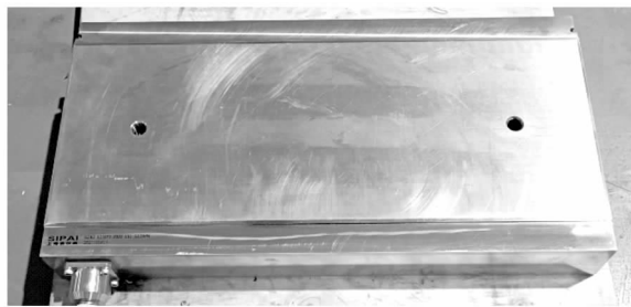
图2 上海自仪院生产的12.5 MN电阻应变式轧制力传感器
