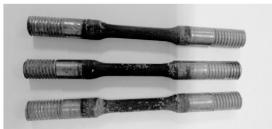
图5 抗硫化氢腐蚀试验后试样形貌
